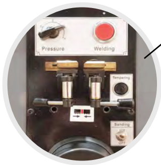
Knip-, las- en slijpinrichting t.b.v. lintzaagblad
