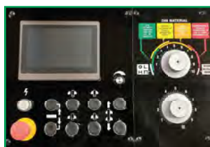
Bedienpaneel met 7" touch screen
