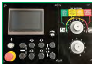
Bedienpaneel met 7" touch screen
