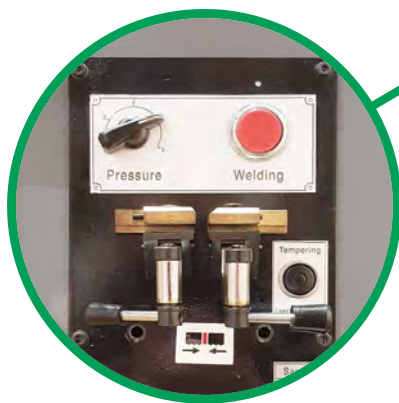
Knip-, las- en slijpinrichting t.b.v. lintzaagblad
